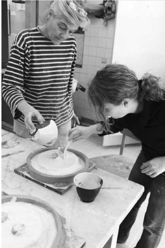
Ingrid Jäger und Viviane Gernaert beim Gießen einer Gipskappe; Foto: Thomas Schelper
