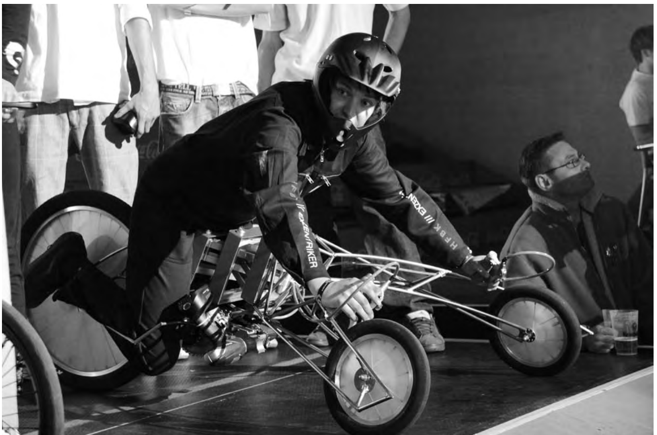
Das Rennfahrzeug mit Akkuschrauberantrieb der Designergruppe »Die Exzentriker«, Hildesheim 2009
