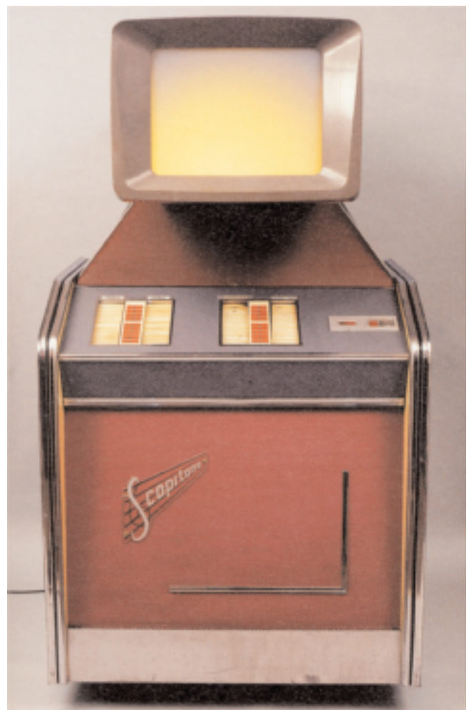
Scopitone Filmbox, Frankreich 1958. Von der französischen Firma Cameca als filmisches Pendant zur Wurlitzer Schallplatten-Jukebox entwickelter Apparat, mit dem 36 bis zu 6 Minuten lange Musikfilme vom Publikum frei wählbar waren. ©Sammlung Werner Nekes
