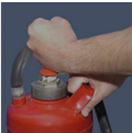
Auslöseeinrichtung bedienen z.B. durch Eindrücken des Schlagknopfes
